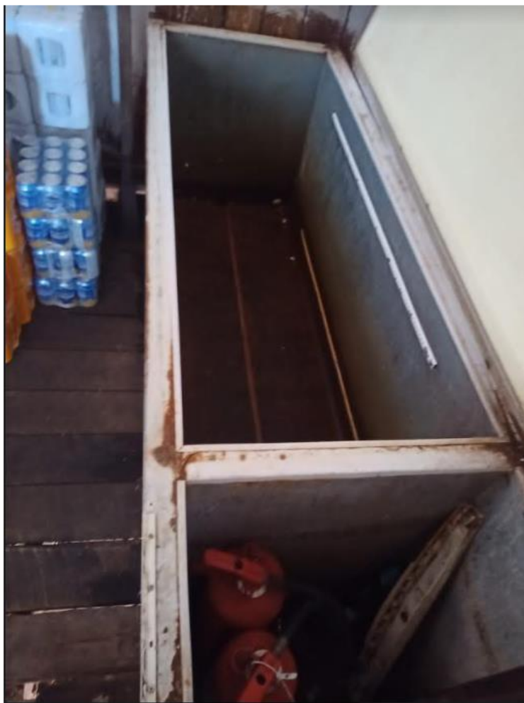
Figura 2 CAOTEC/ GATI: Geleiras sujas e com excesso de oxidação
