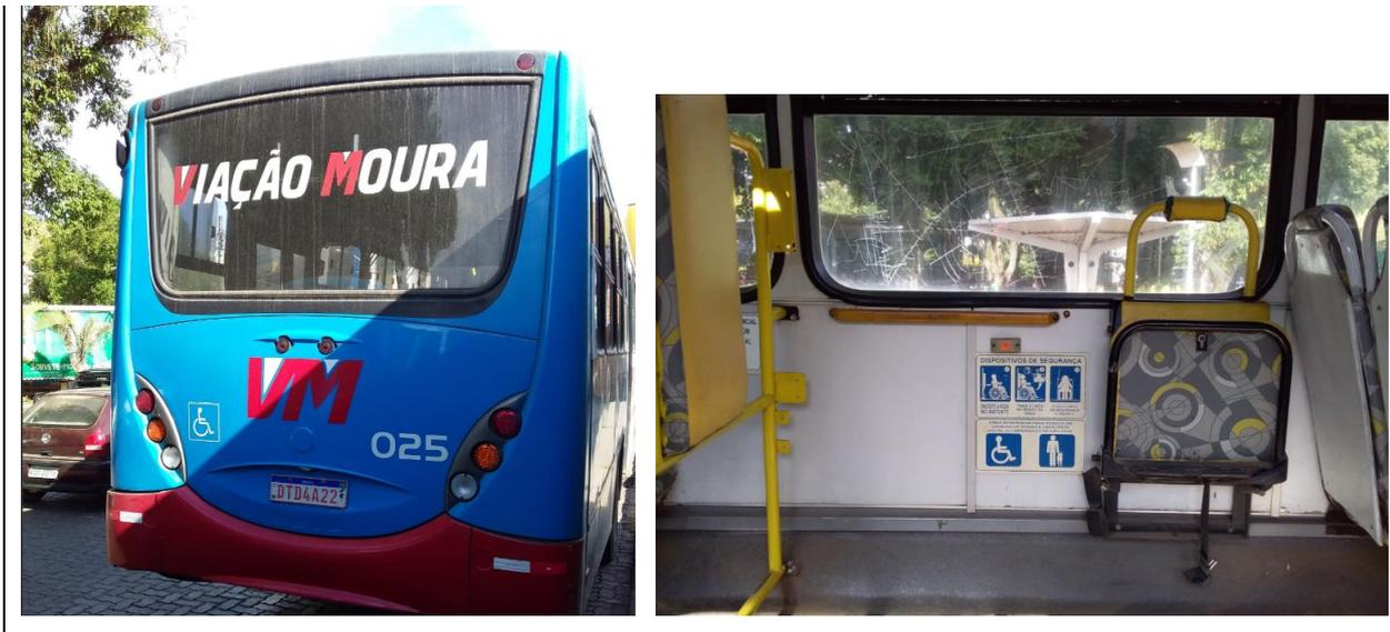
Já naquele ponto, há 5 anos e menos de 6 meses após o início da prestação de serviço pela concessionária, chamava grande atenção o estado precário da frota utilizada: todos os pneus absolutamente “carecas”, degraus com pisos antiderrapantes descolando e gerando risco de queda, vidros sujos, arranhados e trincados e um estado geral de higiene, interno e externo, preocupante.
