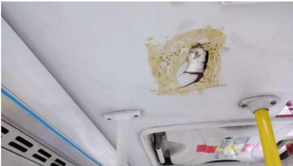
. Carro D53579 da linha 397 com revestimento interno do teto danificado.
